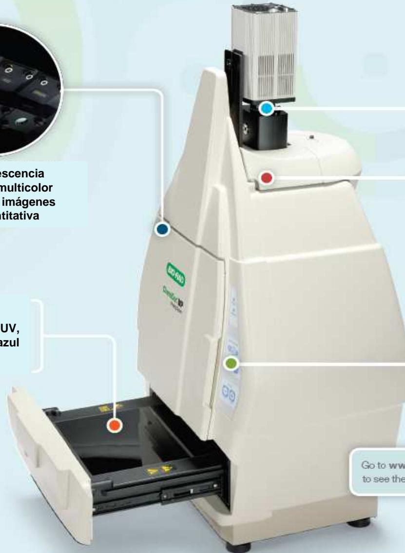
Cámara CCD superenfriada con enfoque automático para todos los niveles de zoom. Sensibilidad y calidad de imagen sin precedentes.
